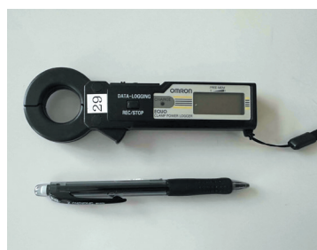
測定時に使用したCTロガー(クランプ式)
